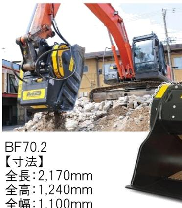
解体工事や現場残留物のリサイクルや中小規模の破碎工事はMBバケットクラッシャーBF70.2が最適です。
