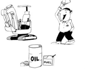
完全なフロントアタッチメントを装備し、オペレータを含んだ時の総質量
