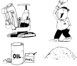
運転質量に最大積載質量を足した質量です。最大積載質量は次の算式で算出できます。
