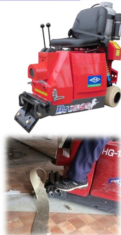
ブロンコは速さと剥離能力を追求して誕生した搭乗式床材剥離機で、移動は前後操作レバーで楽々。
